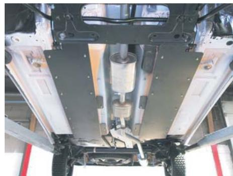
La protection sous moteur sert de "ski" en cas de contact avec le sol. Deux tôles latérales protègent les canalisations de freins et carburant.
