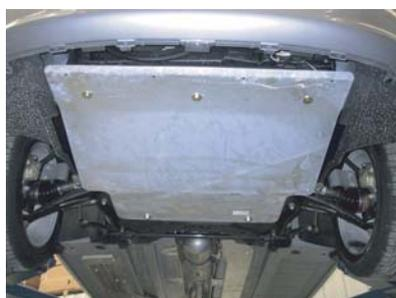
Protections inférieures spécifiques sous moteur et sous caisse.
