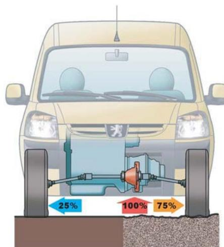
Sur les véhicules à motricité renforcée, le différentiel à glissement limité transfère 25 % de la puissance à la roue qui adhère le plus au sol.
