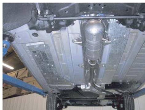
La protection sous moteur sert de "ski" en cas de contact avec le sol. Deux tôles latérales protègent les canalisations de freins et carburant.
