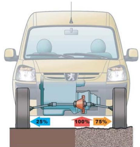
Sur les véhicules à motricité renforcée, le différentiel à glissement limité transfère 25 % de la puissance à la roue qui adhère le plus au sol. Ceci permet au véhicule de continuer à avancer avec une roue sur terrain glissant.
